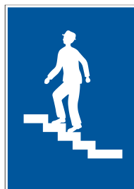
4.13 Passerelle pour piétons (art. 47)
